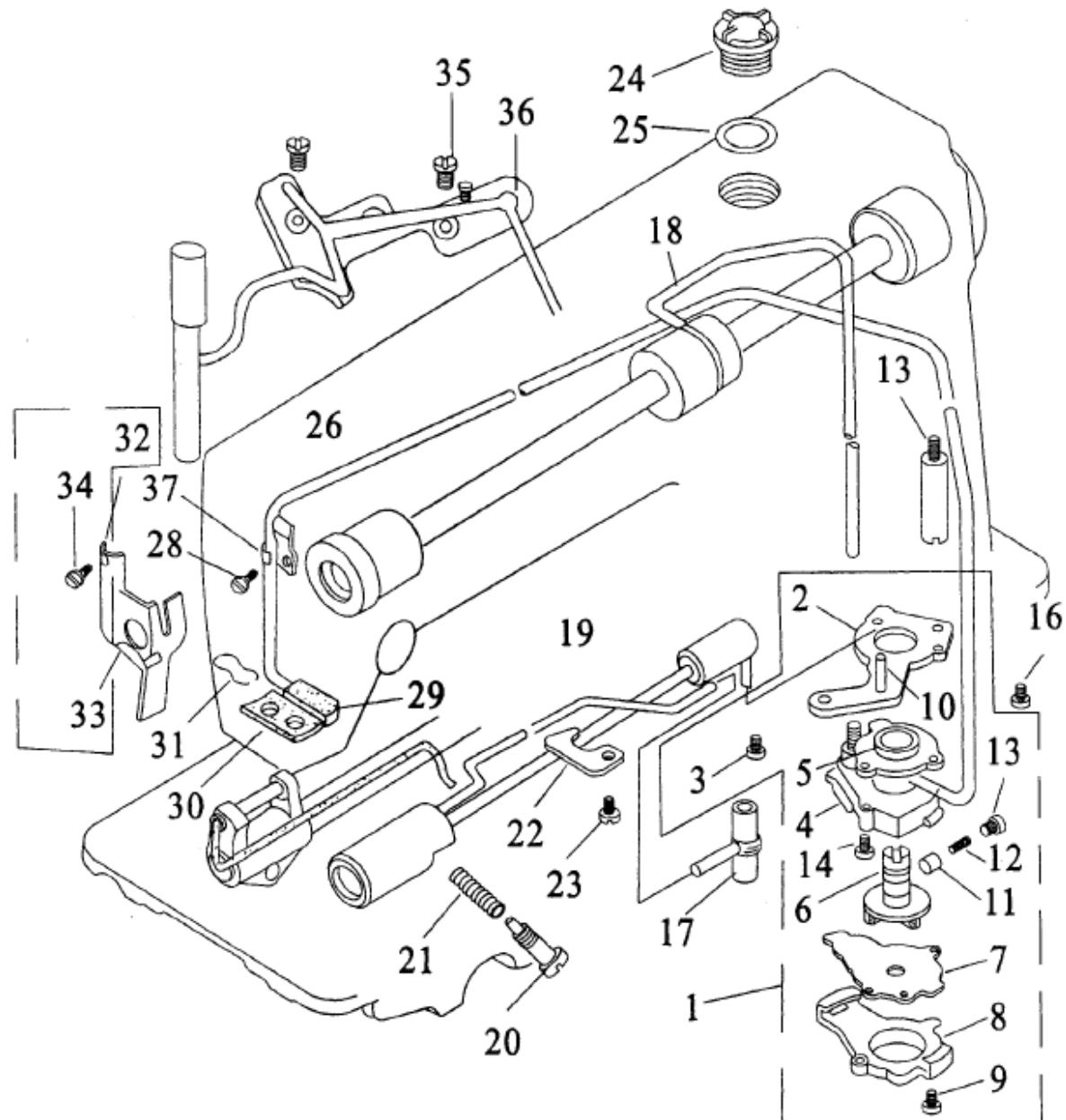
Стр. 29 Части масляного резервуара и коленоподъемника для прижимной лапки
