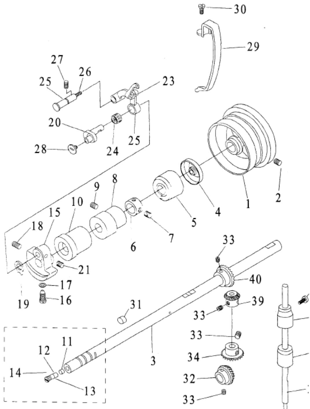
**3. Части стержня иглы и устройства натяжения нити**
