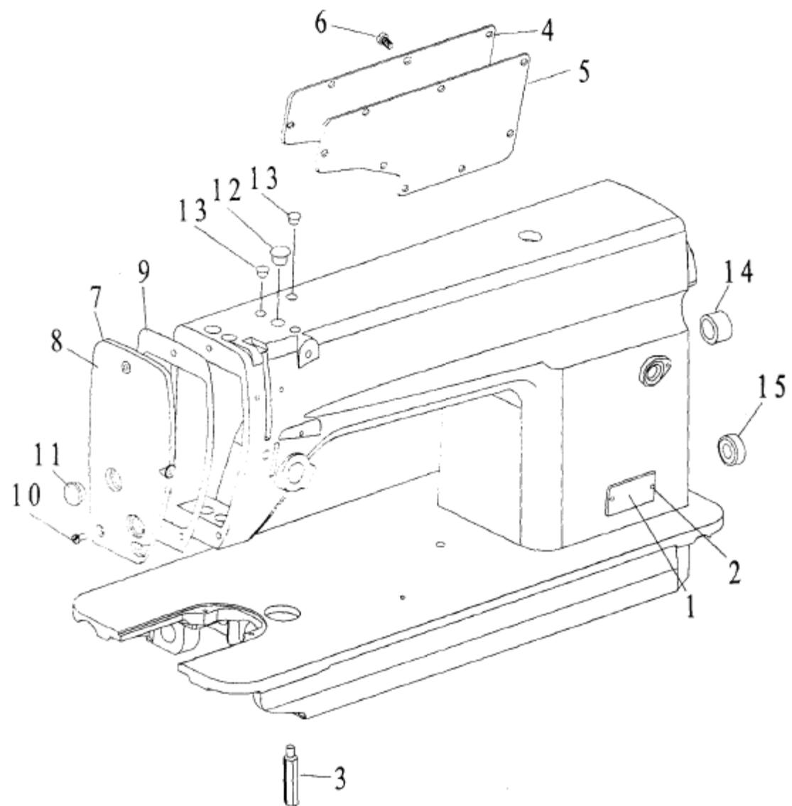
**2. Части главного вала привода и натяжного устройства**
