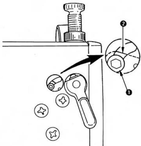
利用松线解除机构, 缝制中也可以提升上线也不松线。
