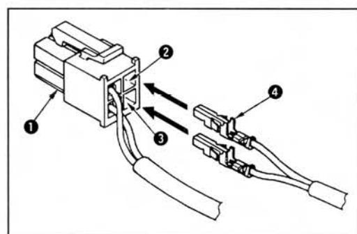
请把选购件开关的电缆插入到从机头部引来的4P插头①的②和③,可互换(没有极性)。因为插销针的插入方向有规定,所以请把突起部④朝上插入。
