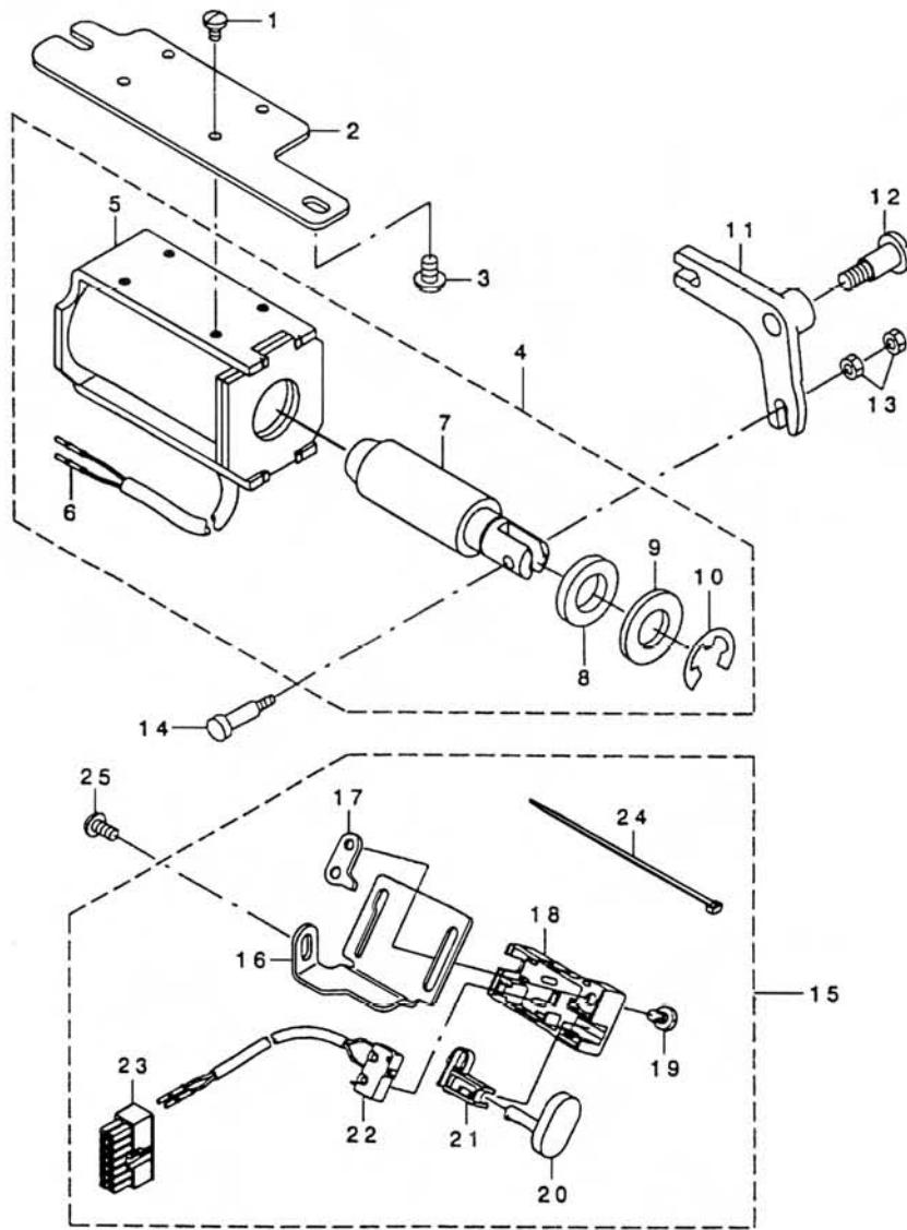
九(一)、小鸟巢电磁铁组件 (8990DN-3SS) (8990DN-4SS)
